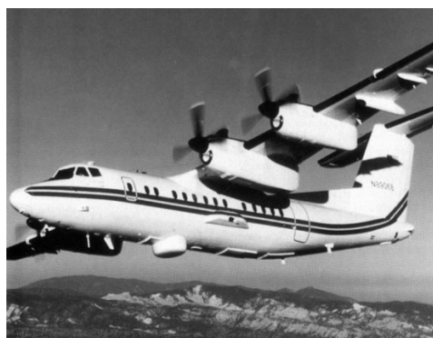
Рис. 3. Система армейской многофункциональной авиационной разведки ARL-M, установленная на самолете-разведчике RC-7B
